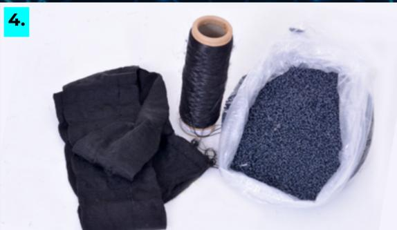
Resíduos têxteis de poliéster transformados em pellets usados na extrusão de novos filamentos têxteis.
