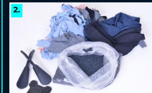
2. Resíduos têxteis sintéticos (poliamida e poliéster) transformados em pellets usados na injeção de peças plásticas.
