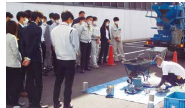
生コンクリート受入検査の実演
