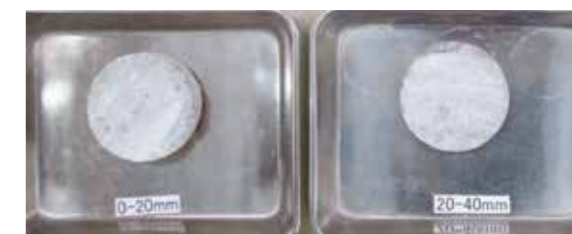
加工後のコンクリート供試体(20mmピッチでカット)
