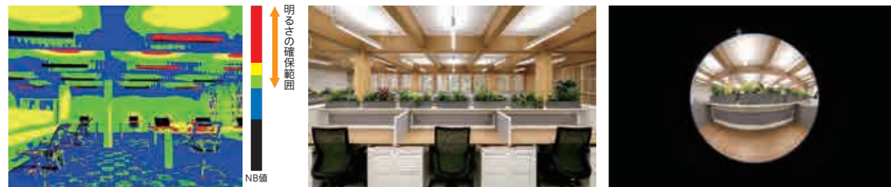
設計段階からシミュレーションで空間の明るさ検討を行います。ZEBのような省エネルギーにおいても明るい環境を実現します。
