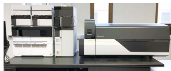
ワシントン大学との共同研究に用いている高速液体クロマトグラフ質量分析計 [LCMS-8060]
