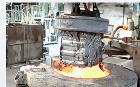
鋳造用溶解炉への材料投入の様子
