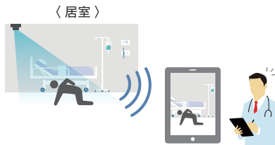
骨格認識技術と3次元カメラを用いて転倒を検知
