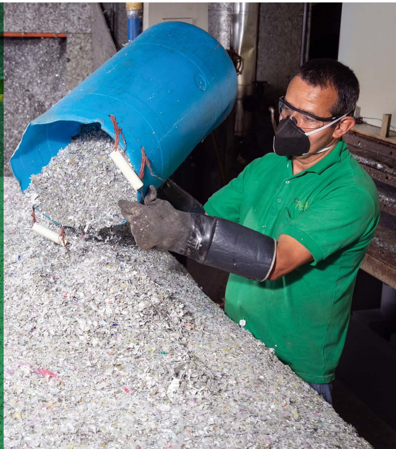
Proceso de reciclaje de Tetra Pak para convertir el material en mobiliario del programa MiPupitre Postobón.
