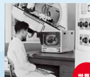
1961 放射線の被ばく低減 遠隔操作式X線テレビ装置を開発
