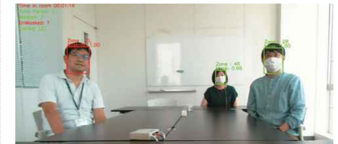
画面左の人物がマスクをしていないことを「NRI AI Camera for Office」が検知(赤枠表示)し、音声でマスクを着用するよう警告
