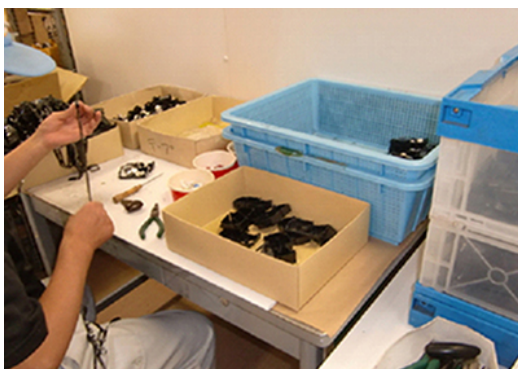
テープカートリッジとインクリボンカセットの分解・分別
