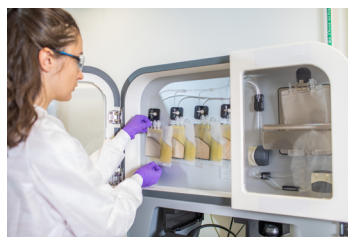
充填・仕上げシステム
