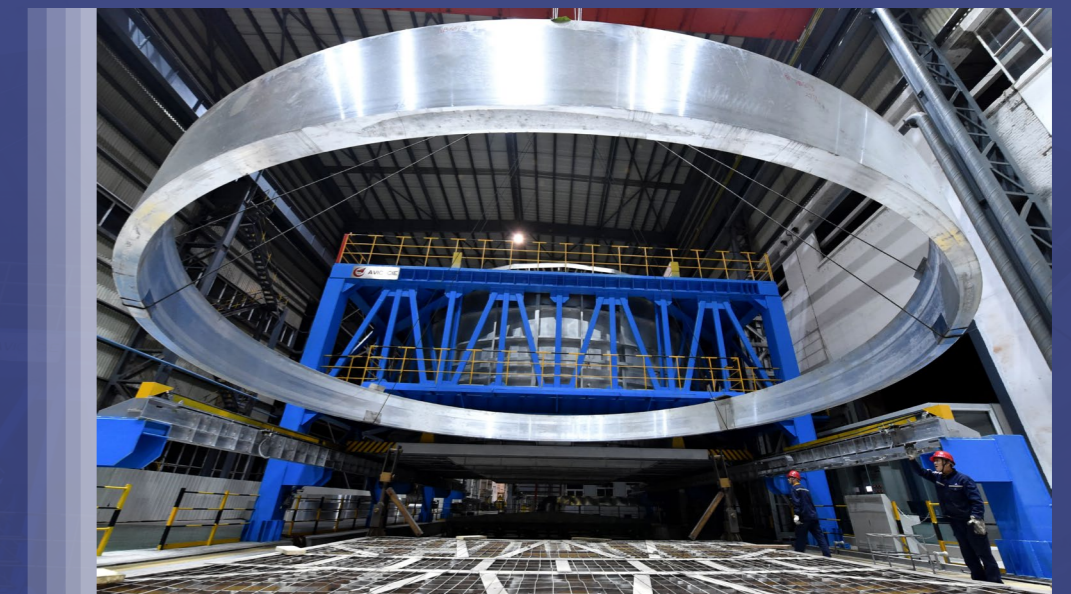
西南铝研制的直径 10 米级铝合金锻环
