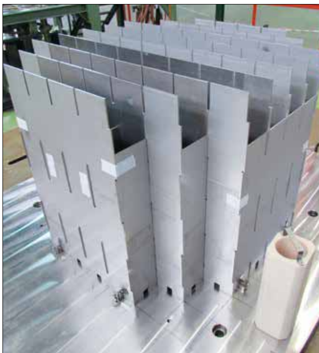
Racks de acero inoxidable para almacenamiento de combustible gastado en piscina de central nuclear.
