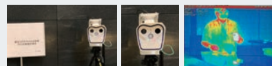
入退館ゲートにサーマルカメラを設置。来館者の体温を確認。
