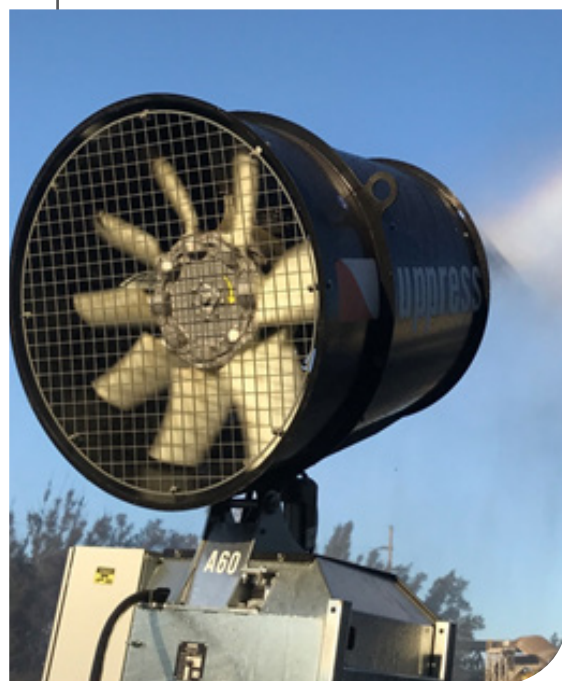
Canhão de névoa em operação na Usina de Ipatinga
