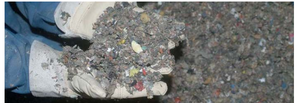
Desarrollo de nuevos CSR (combustible sólido recuperado) de alto contenido energético a partir de residuos urbanos e industriales.
