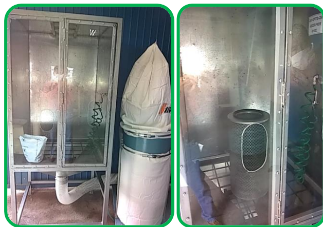
Equipo de limpieza de filtros
