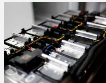
高压动力电池模块在华晨宝马动力电池中心进行组装。
