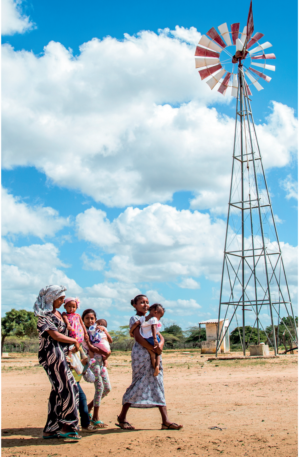
Molinos de viento en el municipio de Manaure (La Guajira) que permiten abastecer de agua a las comunidades
