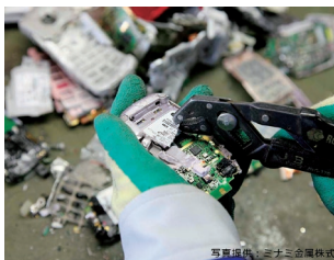
回収した携帯電話の解体作業
