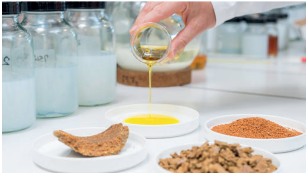
> Worlée nutzt das gewonnene Leindotteröl als Basis für Bindemittel. Der Leindotterpresskuchen wird in die Futtermittelindustrie vertrieben
