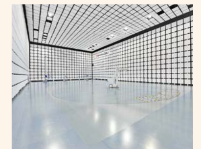
クオリティセンターの電波暗室
