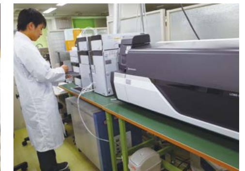
マイクロプラスチックの付着物質の分析を行う 高速液体クロマトグラフ質量分析計
