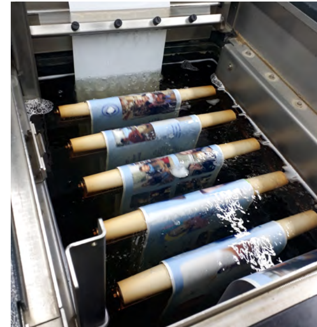
Ein Blick in die VSP25 zur fotografischen Entwicklung von Papier mit hocheffizientem Abstreifersystem.
