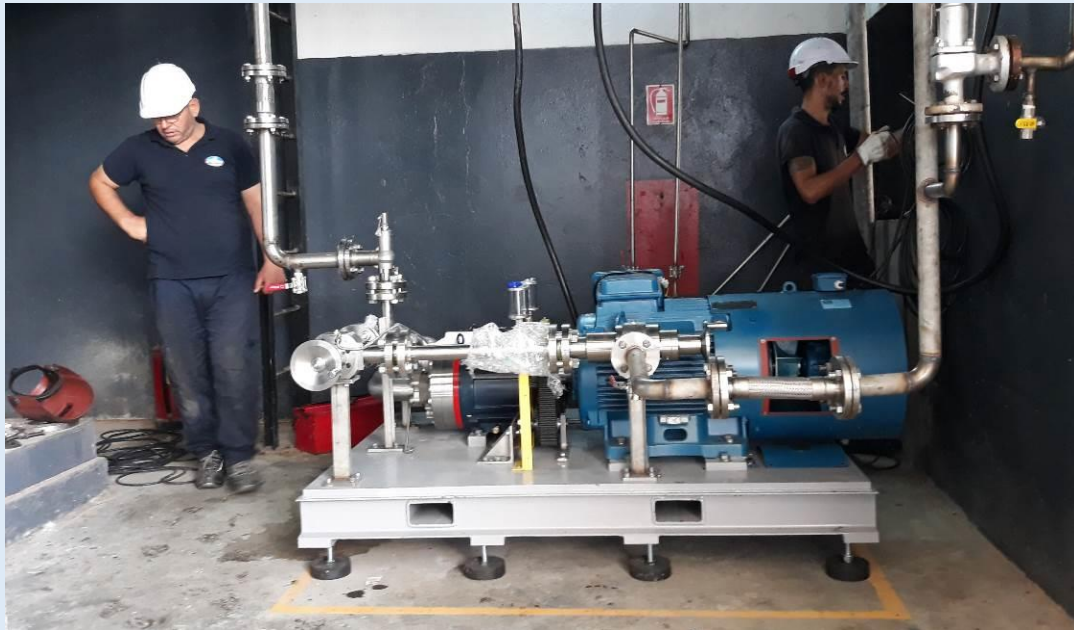
Oct-2019 Une nouvelle technologie de « nano cavitation » au niveau de l'étape dégommage/neutralisation. Le NANO consiste à créer des conditions de pression et de température très particulières qui favorisent le contact à l'échelle nanoscopique des réactifs hétérogènes du mélange « huile et additifs chimiques »
