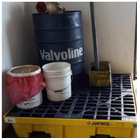
Pallet justrite - 4 barriles perfil bajo: polietileno 45% reciclado. rejillas negras y dique de contención de 49'' x 49'' x 5,5''. capacidad 49 gl. resistencia 5.000lbr.
