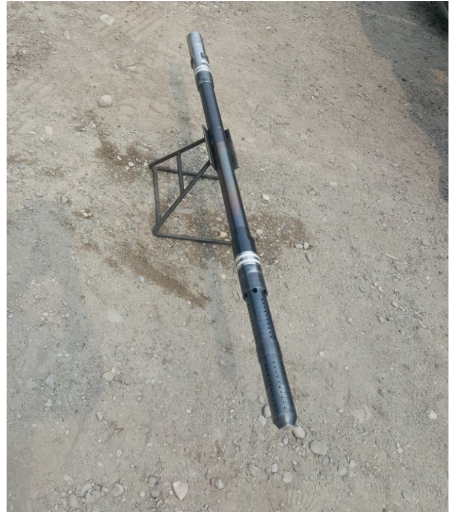
Bomba Jet reparada
