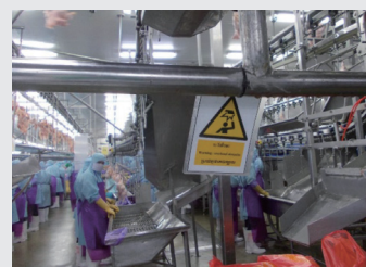
頭を打つ可能性がある箇所に安全標識を設置
