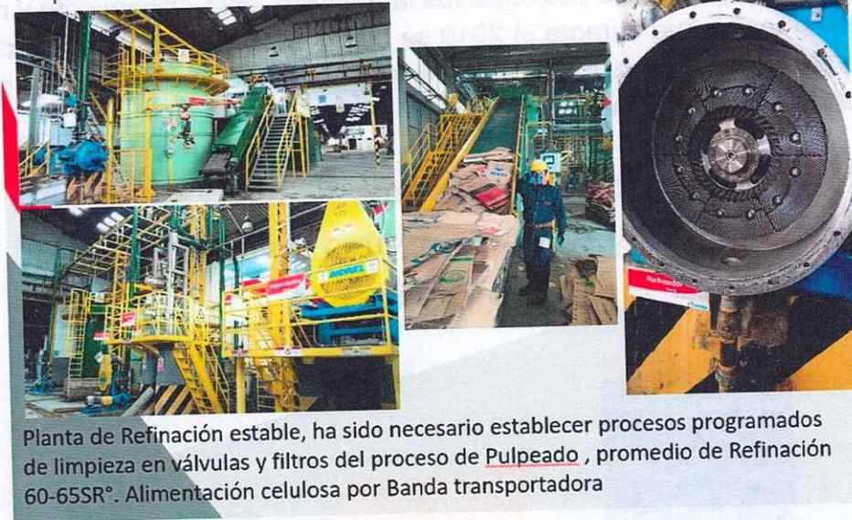
Planta de Refinación estable, ha sido necesario establecer procesos programados de limpieza en válvulas y filtros del proceso de Pulpeado, promedio de Refinación 60-65SR°. Alimentación celulosa por Banda transportadora
