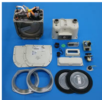
分解したガスメーター
