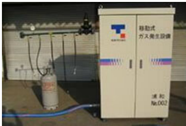
移動式ガス発生設備
