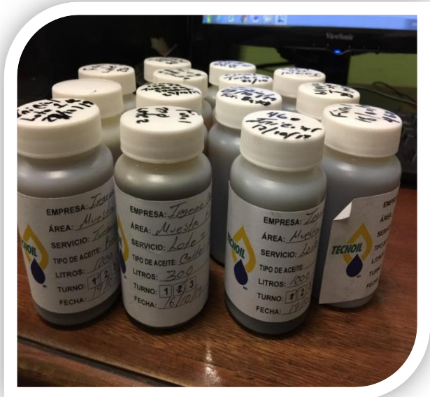
MUESTRAS DE LUBRICANTES ANTES Y DESPUÉS DEL FILTRADO Y CENTRIFUGADO
