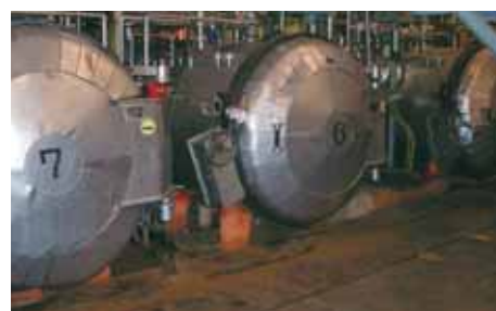
発売当時のレトルト釜。高温での加圧・加熱殺菌により保存料を使わず長期保存が可能に
