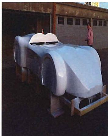
L'objectif de ce projet est de fabriquer une voiture de compétition biplace électrique suivant le règlement de la Fédération Française du Sport Automobile et d'atteindre les 100km/h en 3 secondes. Le groupe Renault a fourni 3 moteurs électriques de Zoé pour assurer la propulsion de ce véhicule.
