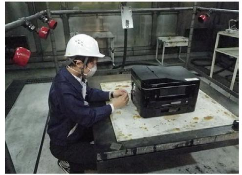
燃焼実験室における燃焼性試験
