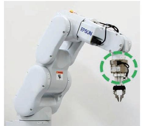
力覚センサーとは、ロボットのアームにかかる力の向きや大きさなどを読み取り、ロボットの動作を高精度に制御するための機器です。これを用いることにより、ロボットに力の感覚を与え、従来は人に頼っていた作業をロボットに置き換えることが可能になります。
