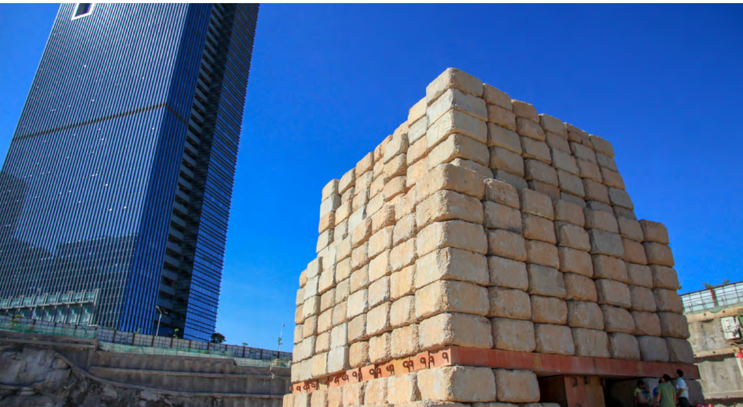
◎ CTC 厦门宏业有限公司静载桩检测现场
