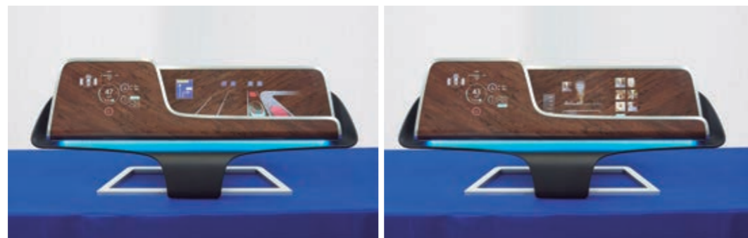
木目調などのデザインが施されたパネルに触れると、カーナビゲーション(左)やカーオーディオ(右)などの画面が浮かび上がり、操作可能となる。
