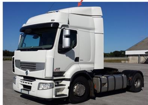
Tracteur 4*2 avec déflecteur d'air aérodynamique
