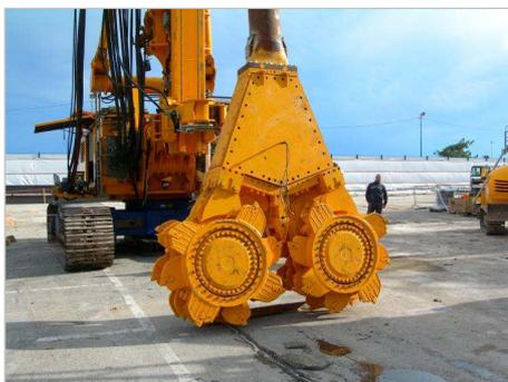
L'unità **CSM** è costituita da due gruppi di ruote fresanti montate su un telaio (dove trovano alloggiamento i motori ed i sensori atti alla misurazione di tutti i parametri di processo). La fresa, azionata idraulicamente, opera nel piano verticale disgregando il terreno mentre la miscela cementizia viene iniettata in continuo a bassa pressione.
