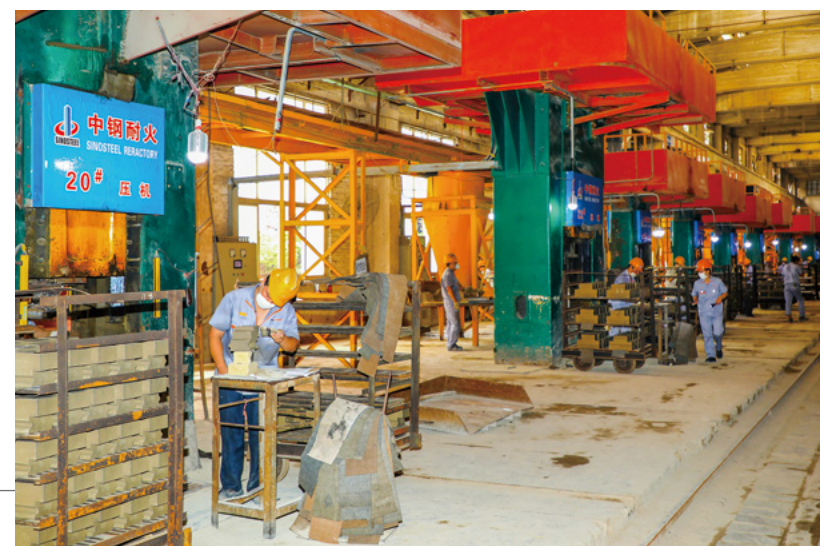
焦炉用新型耐火材料生产现场
