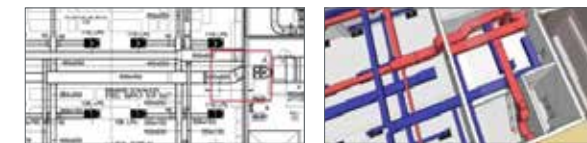
2D도면을 BIM으로 구현하여 간섭사항 도출(예시)
