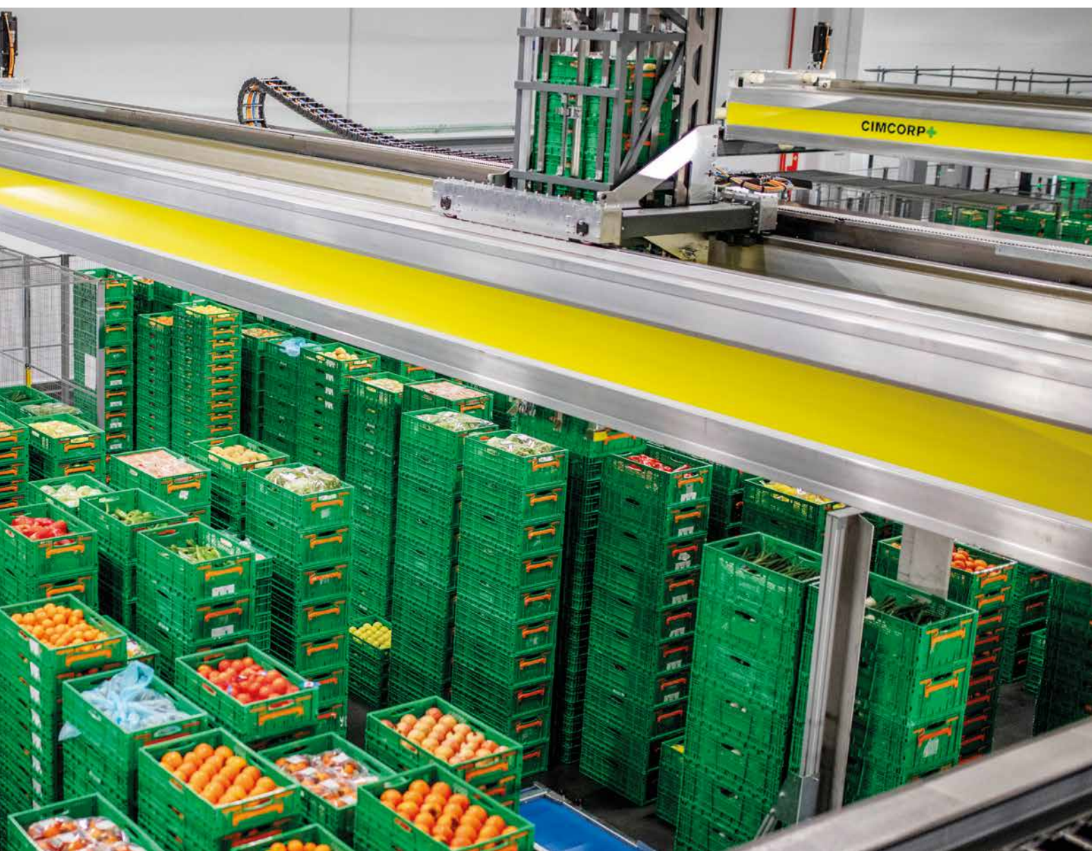
Sistema de Picking Puente Grúa (PPG) en el bloque logístico de Vitoria-Gasteiz, Araba/Álava.
