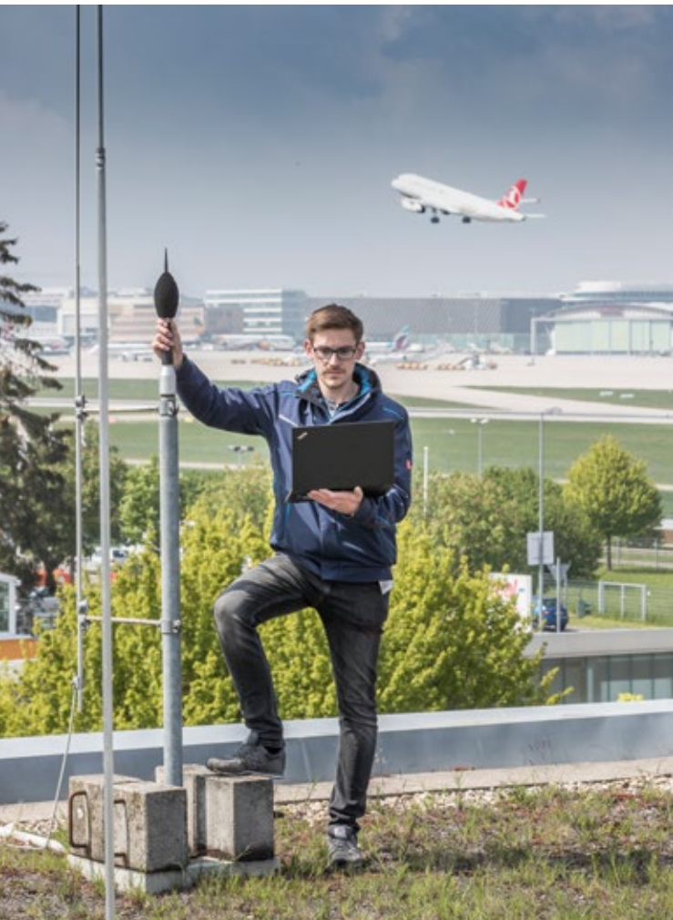
Zuverlässige Messdaten zum Fluglärm liefern acht stationäre Mikrophone am Flughafen und in den Nachbargemeinden. Sie werden regelmäßig justiert.
