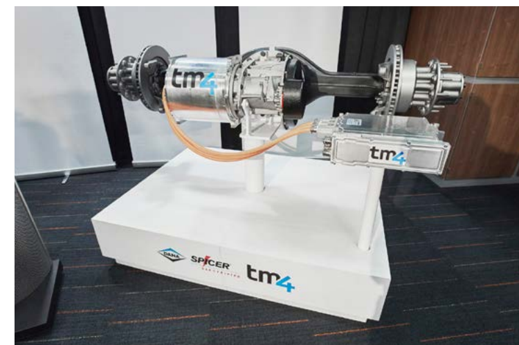
Essieu Dana intégrant un système électrifié TM4 SUMO (moteur et onduleur).
