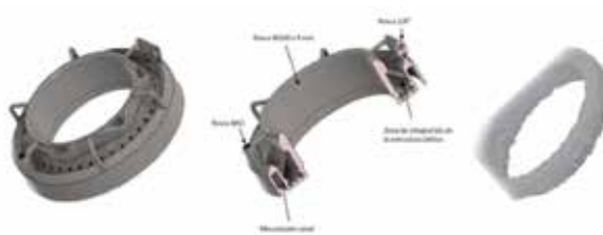
Scanning en 3D, rediseño y fabricación aditiva de piezas destinadas a mejora de nuestros medios productivos.
