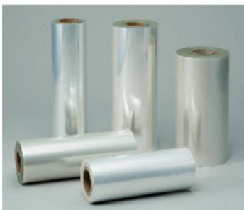
PETフィルムは、独自の二軸延伸効果によって他のプラスチックフィルムには見られない耐熱性、ガス遮断性、防湿性、強度、透明性など、各特性のバランスがとれたフィルムです。寸法安定性や加工適性に大変優れることから、食品用のラミネート基材から産業資材に至るまで幅広く展開しています。
