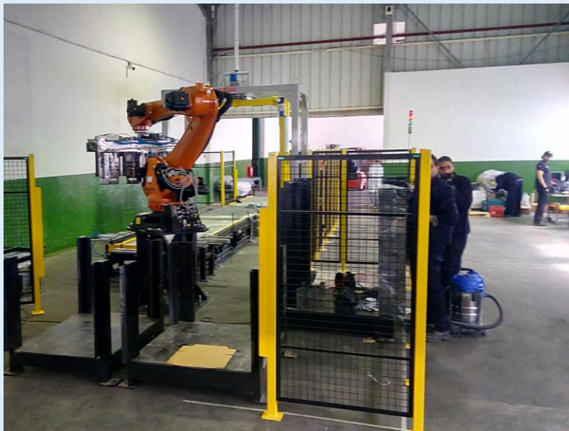
Installation d'un robot en fin de chaîne de conditionnement avril 2018
