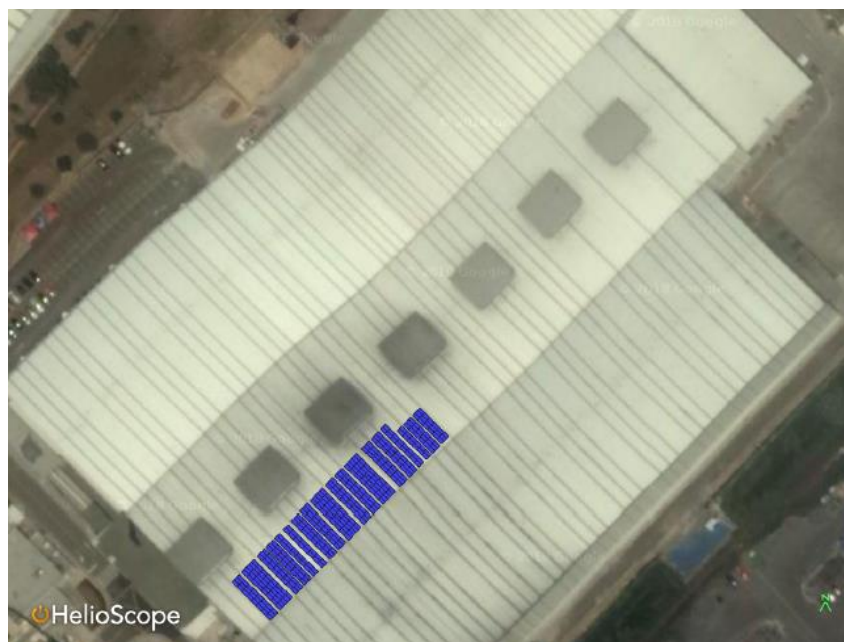
Ilustración 1 Diseño planta de energía solar ELC
