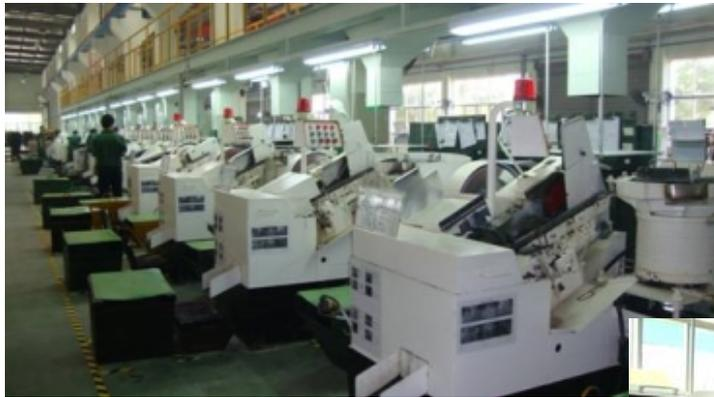
螺栓成型机: 12 台(M5~M12)
