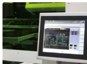
ファイバーレーザー複合加工機で、ネスティング通りに部品を加工している様子
