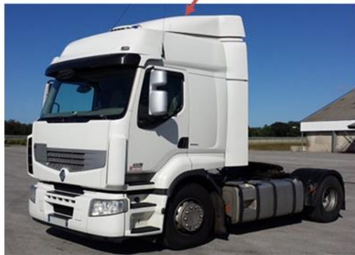
Tracteur 4*2 avec déflecteur d'air aérodynamique
