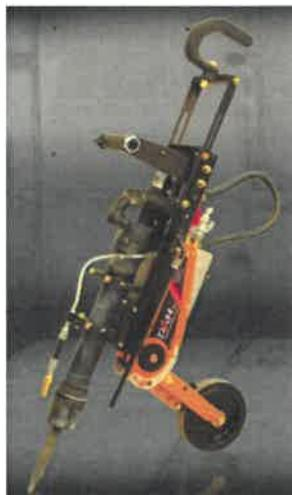
Principe : Il réduit de manière significative les risques de blessures, mais aussi les vibrations ressenties au niveau des mains de l'opérateur, grâce à son système de ressorts et plateau coulissant, qui isole les vibrations occasionnées par l'action de l'écaillage du marteau-piqueur. Dès que le marteau-piqueur entre en fonction, une légère bruine d'eau est automatiquement projetée sur la surface de travail, afin d'empêcher le soulèvement de la poussière d'écaillage.
